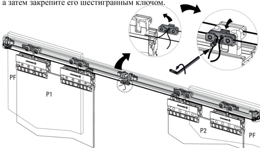
Затем при закрытых дверях поместите трос в кабельную опорную плиту двери 2 (P2) и закрепите трос шестигранным ключом.
