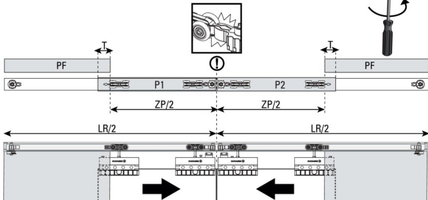
Закрепите стопора отверткой, как показано на рисунке.
