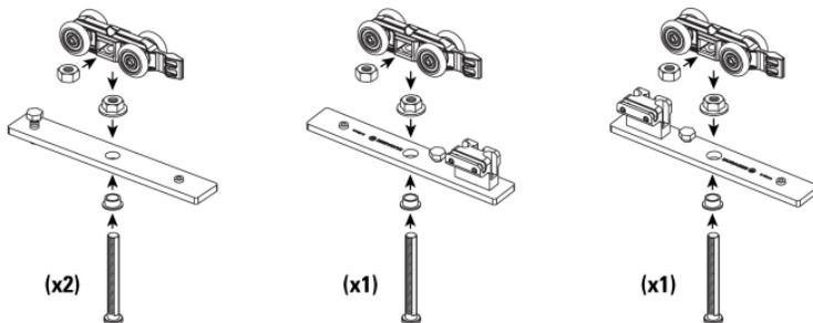
Вставьте стопоры DN 80, держатели и стопоры шкивов в направляющую, следуя положениям показанным на схеме
