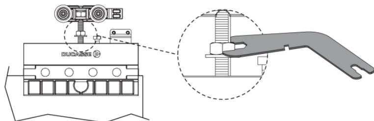
Закрепите накладки в зажимах, а затем закрепите правую и левую торцевые заглушки с обеих сторон шестигранным ключом.
